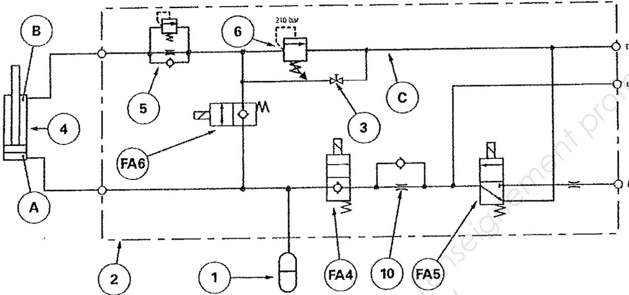
2.5 Quelle est la procédure de dépose de l'accumulateur ?
