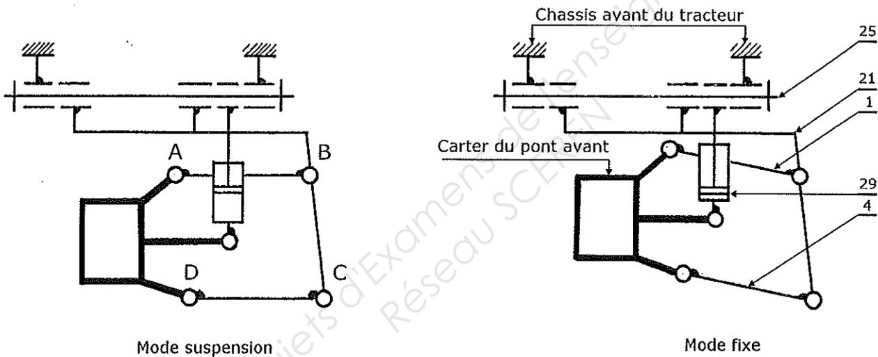
1.5 Pour quelle raison le polygone ABCD est-il un parallélogramme déformable ?
